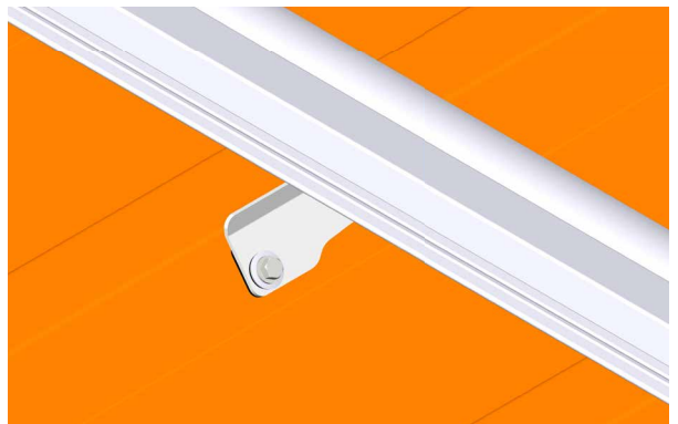
4d. Mit zwei Dünnschrauben 6.0x25 DS am Trapezblech anschrauben.
